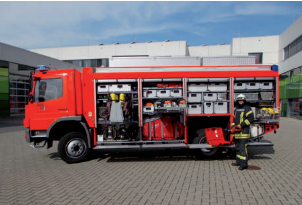
Kombinierter Rüst und Gerätewagen Gefahrgut
